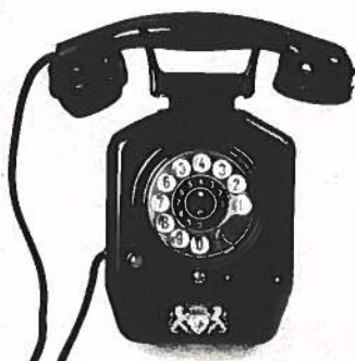
fig. 17. Tafeltoestel voor automatisch kiezen, fabrikaat Siemens und Halske. Vervaardigd van zwart gemoffeld plaatstaal. Dit type toestel werd vervaardigd met gebruikmaking van de octrooien van Strowger, de uitvinder van het systeem voor automatisch kiezen.
