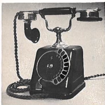
fig. 17. Tafeltoestel voor automatisch kiezen, fabrikaat Siemens und Halske. Vervaardigd van zwart gemoffeld plaatstaal. Dit type toestel werd vervaardigd met gebruikmaking van de octrooien van Strowger, de uitvinder van het systeem voor automatisch kiezen.
